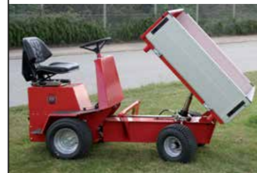
HTF Farmer Truck Robust og stærk maskine. Laster op til 500 kg. Fæses med el- eller benzinmotor. Leveres med 3 vejs tiplad og hydraulisk fremdrift
